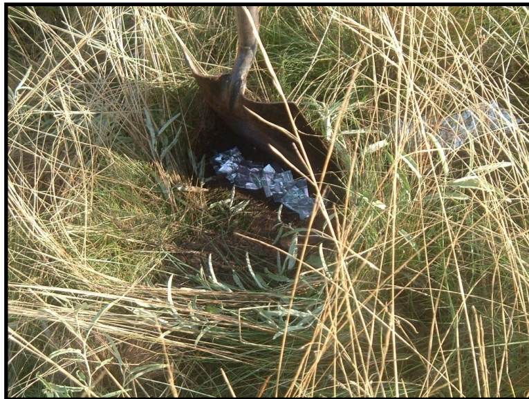
Figura 15 b. Conjunto de crayones colocados a 2 y 4 cm de profundidad.
