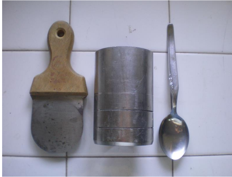
Figura 16. Cilindro utilizado para la toma de muestras de suelo.
