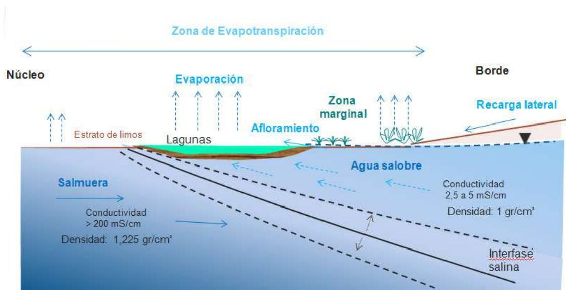
**Figura 3-18.** Esquema de Alimentación Lagunas del borde Salar, SGA, 2013
