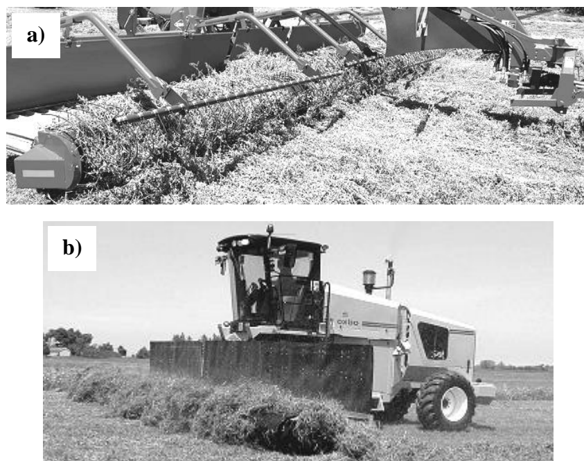
Figura 89: rastrillos con noria para transportar lateralmente al forraje. Fuentes: (a) Kuhn S.A, 2011; (b) Oxbo Int. Corp., 2013.
