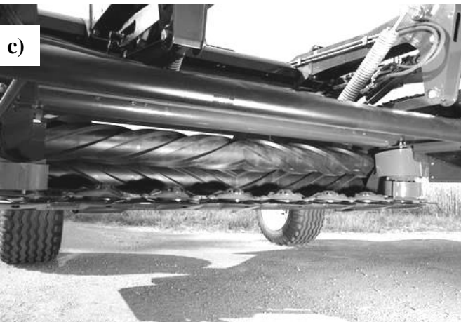
Figura 40: cortadoras hileradoras (a) con hélices, (b) tipo tambor y (c-d) de discos, respectivamente. Fuentes: (a) www.mainero.com.ar ; (b) http://www.magrama.gob.es ; (c) http://es.vicon.eu ; (d) CNH; 2009.
