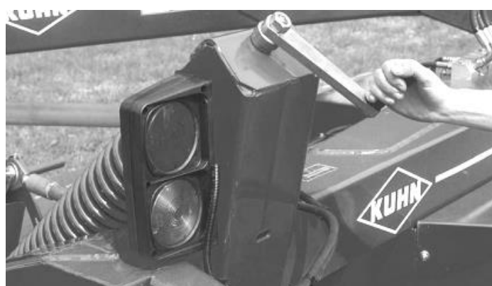
Figura 54: imagen que muestra la operación de regulación de tensión del muelle lateral del que cuelga la barra de corte. Imagen disponible en http://www.kuhnnorthamerica.com/ .
