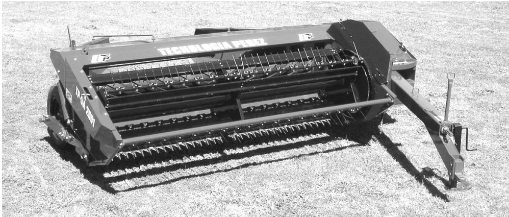
Figura 38: máquina segadora con sistema de corte alternativo, de fabricación nacional. Fuente: Tecnología Perez, 2014.
