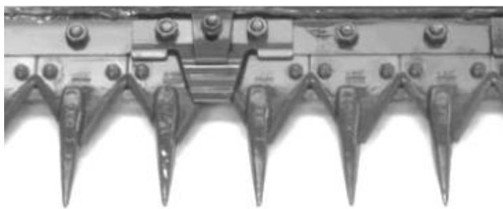
Figura 35: componentes de la barra de corte de una segadora de fabricación extranjera, con distinto diseño de puntones. Fuente: CNH, 2009.
