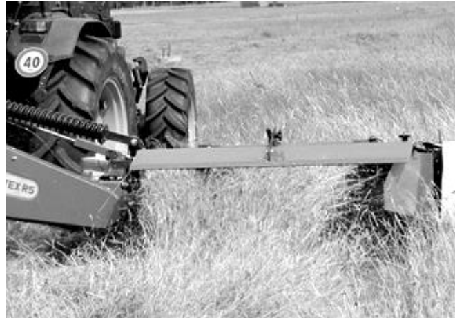
Figura 37: máquina segadora con sistema de corte alternativo, con entrega del forraje cortado en forma de manto, en una pastura de gramíneas. Fuente: BCS Group, 2014.
