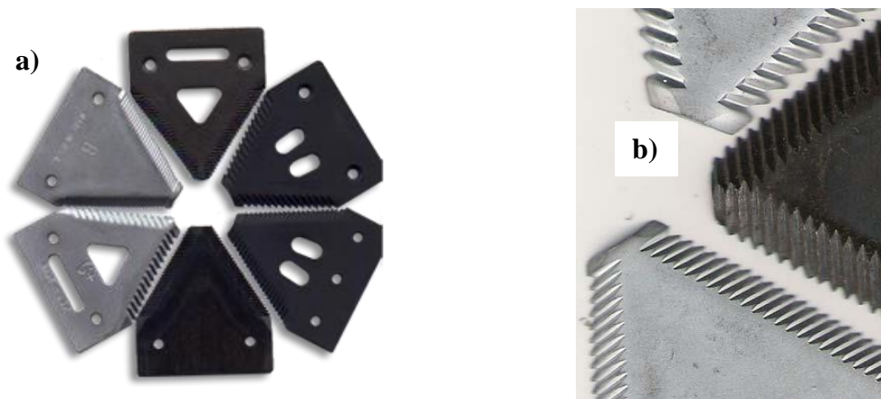
Figura 36: (a) distintos modelos de cuchillas y (b) detalles de los distintos dentados que favorecen el corte sin deslizamiento del tallo a lo largo del filo.
