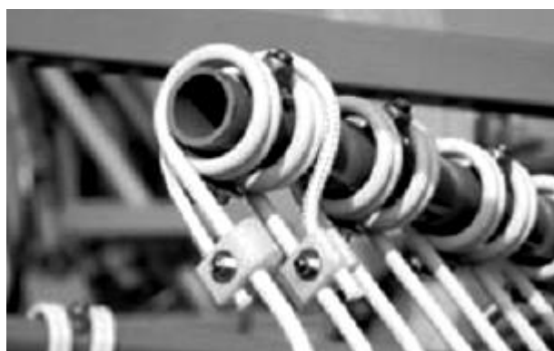
Figura 87: sistema de seguridad para evitar la pérdida de las púas. Fuente: Krone, 2011.
