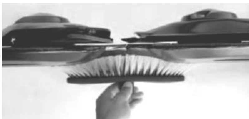
Figura 52: detalle del perfil de una barra de corte con discos. Imagen disponible en http://www.claas.es/ .
