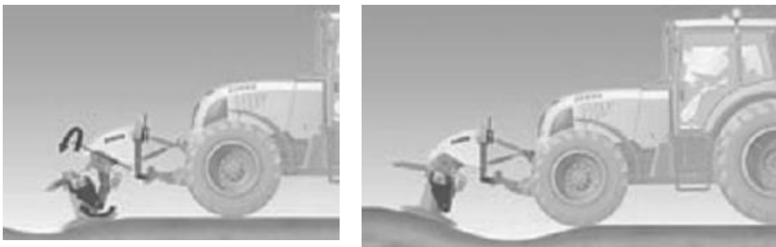
Figura 47: cortadora rotativa de tambores, con movimiento basculante en sentido longitudinal al avance. Imágenes disponibles en http://www.peru.claas.com/
