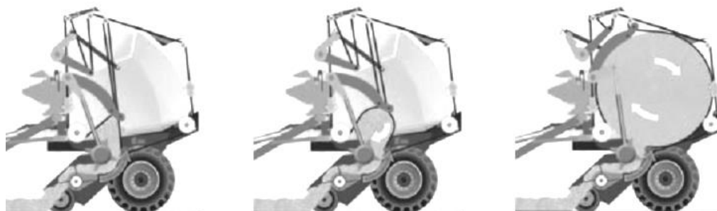
Figura 92: proceso de formación de una paca cilíndrica en una máquina con cámara variable. Fuente: Claas, 2013 a.
