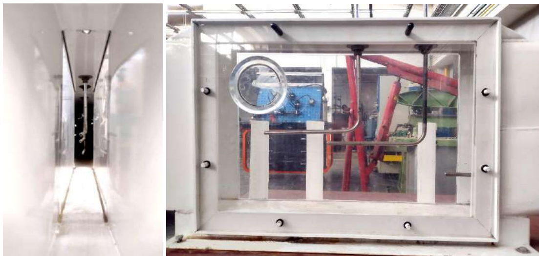
Figura 18: Cámara de ensayo del túnel de viento de la Facultad de ingeniería.
