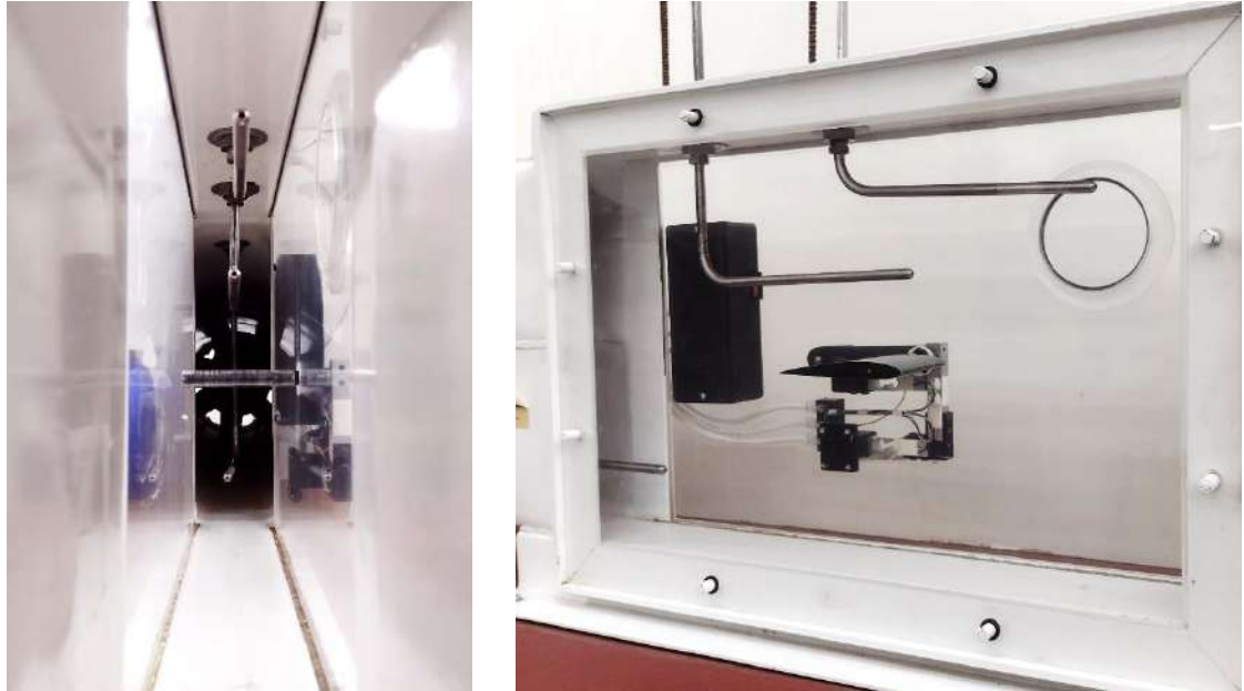
Figura 59: Vista frontal y lateral de la cámara de ensayo con el perfil de ala NACA 2412 en su interior.
