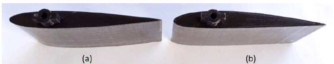
Figura 60: Perfiles alares utilizados en la evaluación del sistema (a) NACA 0012 y (b) NACA 2412.
