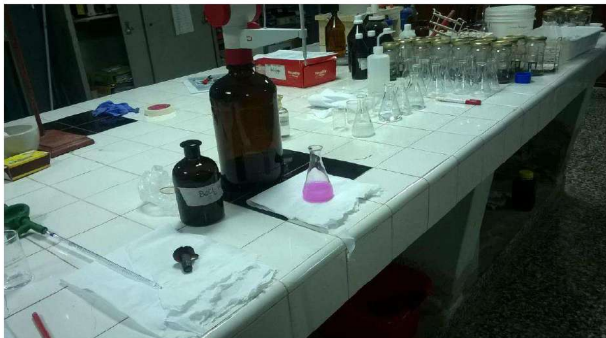
Figura 4: Determinación de respiración edáfica, titulación de NaOH con HCL.
