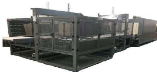
Ilustración 16: Horno termo contraíble.
