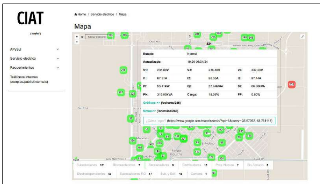
Imagen N° 4: Captura de pantalla del monitoreo de subestaciones. Fuente: Sitio Web del Centro de Información, Automatización y Tecnología (CIAT), CORPICO.
