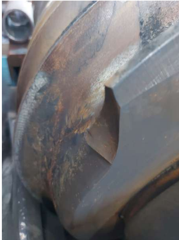
Imagen N°64: Rotura rodillo laminador. Fuente: captura del responsable de producción.
