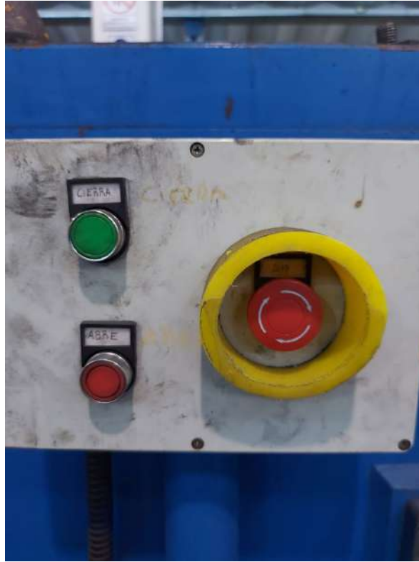
Imagen N°69: Protección parada de emergencia. Fuente: captura realizada por el responsable de producción.
