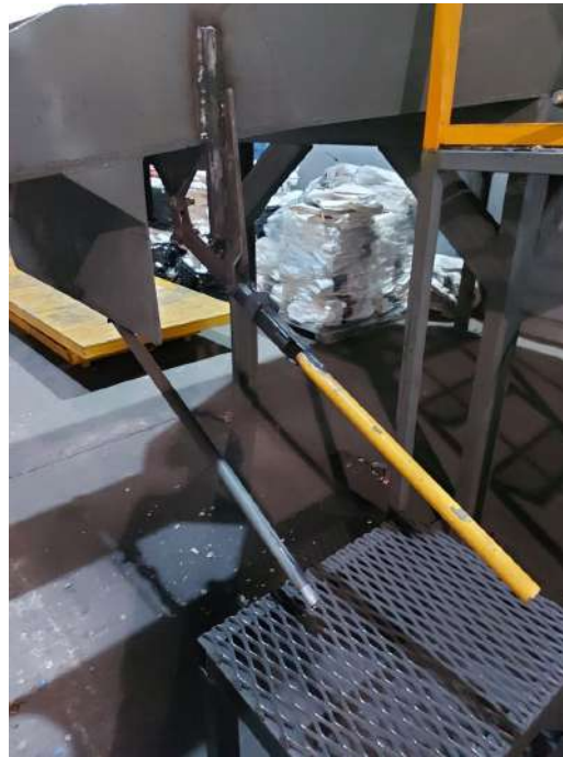
Imagen N°39: Sistema de palancas para accionar las guillotinas de la tolva de envasado. Fuente: imagen capturada por el responsable de producción.
