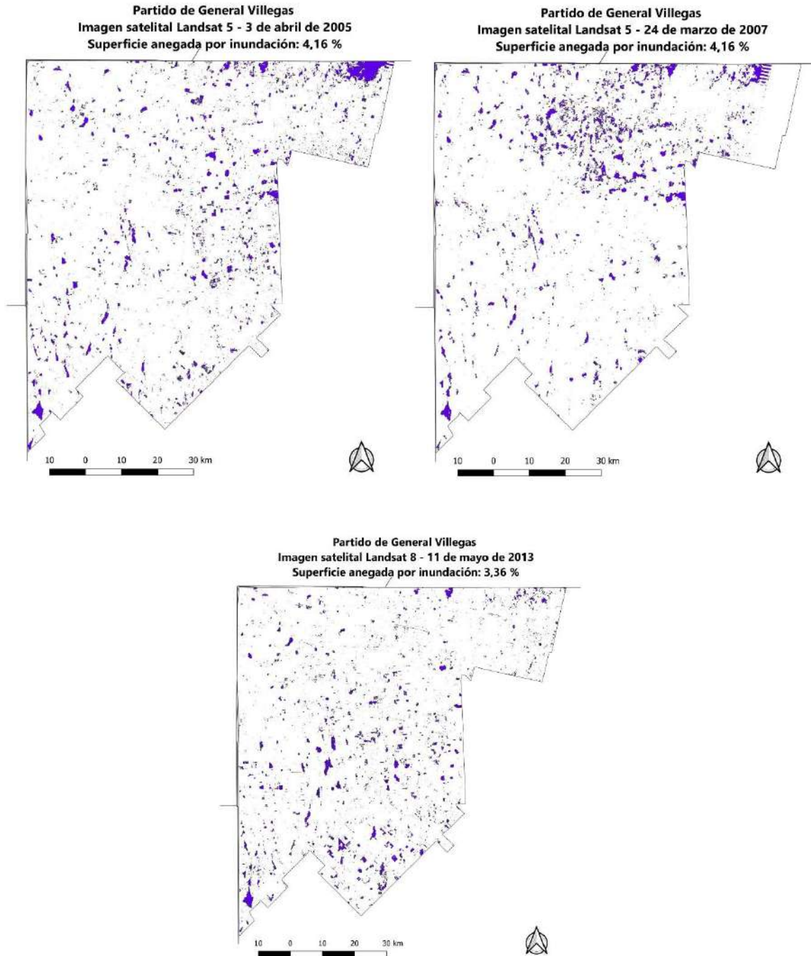
Figura 10. Superficie anegada (%) en General Villegas en los años 2005, 2007 y 2013.
