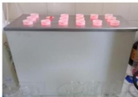
*Figura 4. Prototipo de digestor IR.*
