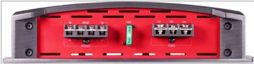
Figura 53: "Vista lateral izquierda del amplificador donde se realizan las conexiones de alimentación y altavoz"
