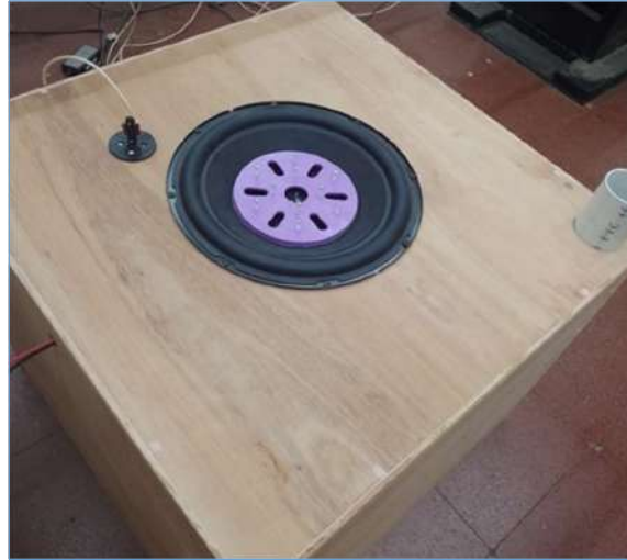
Figura 17: "Pieza-Unión (Violeta) colocada sobre la caja-parlante"
