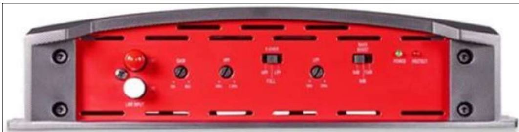
Figura 54: "Vista lateral derecha donde se realizan las configuraciones y se conecta el generador de señales"
