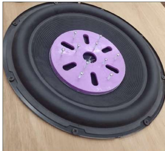
Figura 21: “Pieza unión colocado en la base del parlante”
