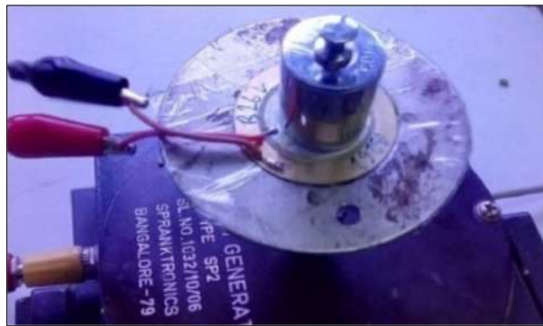
Figura 6: “Disco piezoeléctrico, con masa adjunta colocado sobre el eje del agitador”
