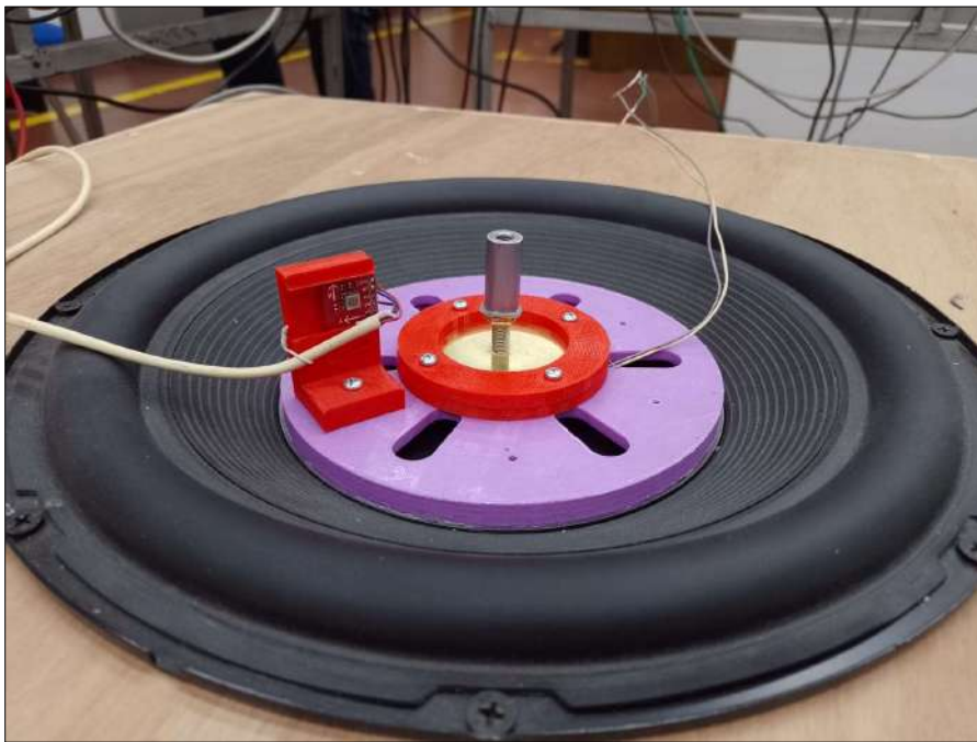
Figura 44: “Segundo y tercer ensayo con una masa de 38,5 [g]”
