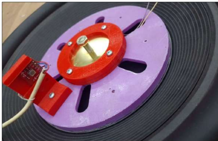
Figura 16: “Pieza-Unión (Violeta), Pieza-Acelerómetro (Rojo) y Pieza-Piezoelectrico (Rojo) colocados en la base del parlante”
