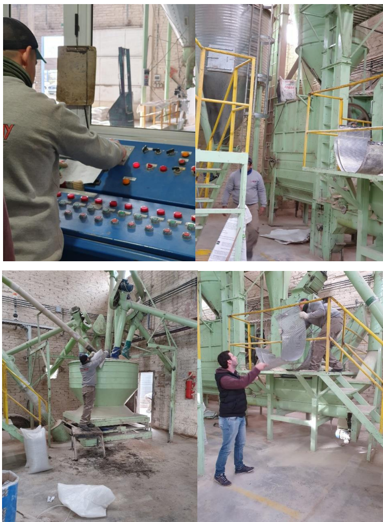
Fotografías 11, 12, 13 y 14): mecanismo de molido, mezclado y peletizado de las dietas experimentales.
