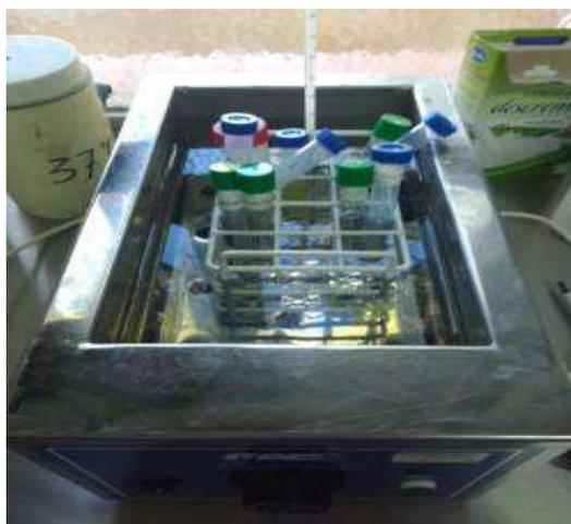
Baño termostático con los medios para ejecución de los experimentos
