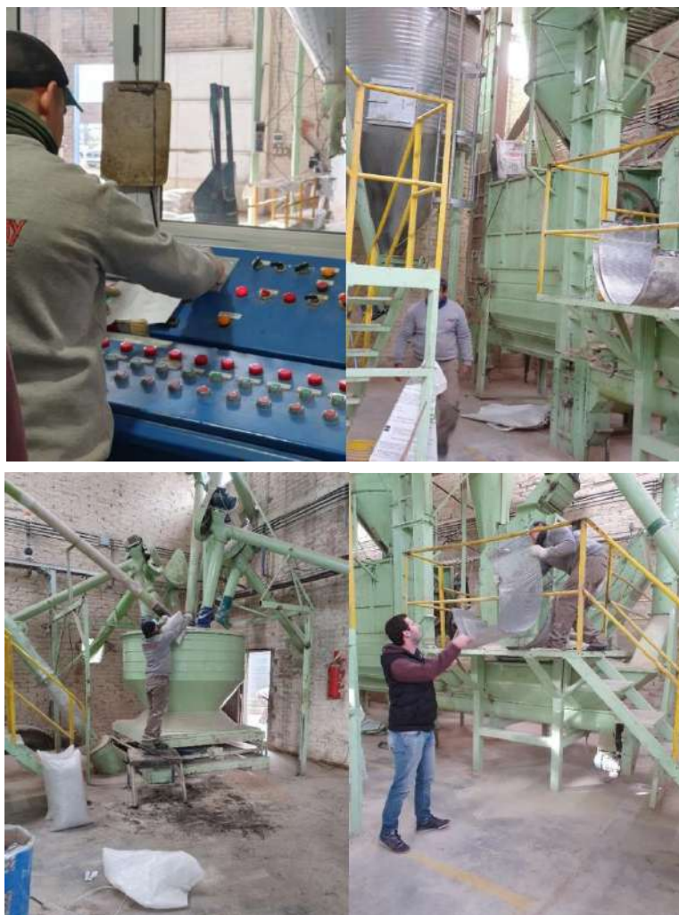
Fotografías 10, 11, 12 y 13): mecanismo de molido, mezclado y peletizado de las dietas experimentales.
