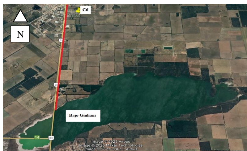
Figura 30. Vía de desagote y canalización de agua, hacia el principal receptor de agua de la ciudad de Santa Rosa, “Bajo Giuliani” ubicado a ambos lados de la Ruta Nacional N° 35.
