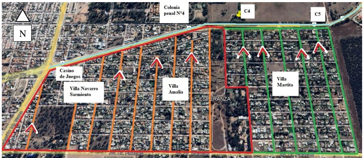
Figura 24. Zona de aporte de agua pluvial a los cuencos pluviales C4 “Cuenco del Penal” y C5 “Cuenco Ruta 5” ubicados sobre la entrada a la ciudad de Santa Rosa, La Pampa.
