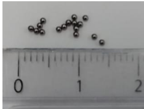
Figura 11: Material granular utilizado en los experimentos: esferas de acero de 1.0 mm de diámetro.
