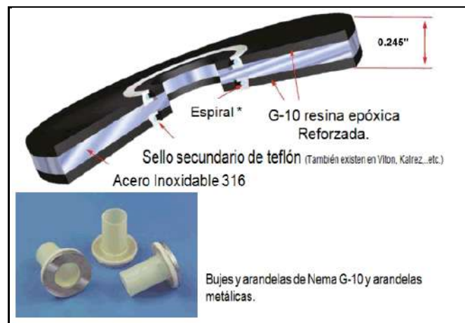
Figura n° 27: Junta Aislante tipo Pikotek
