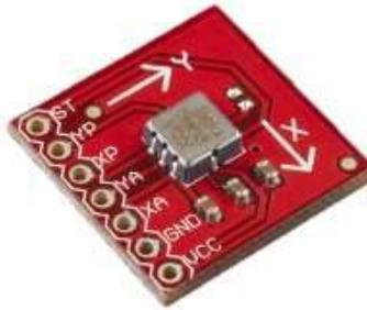
Figura 2.16: Acelerómetro ADXL203
