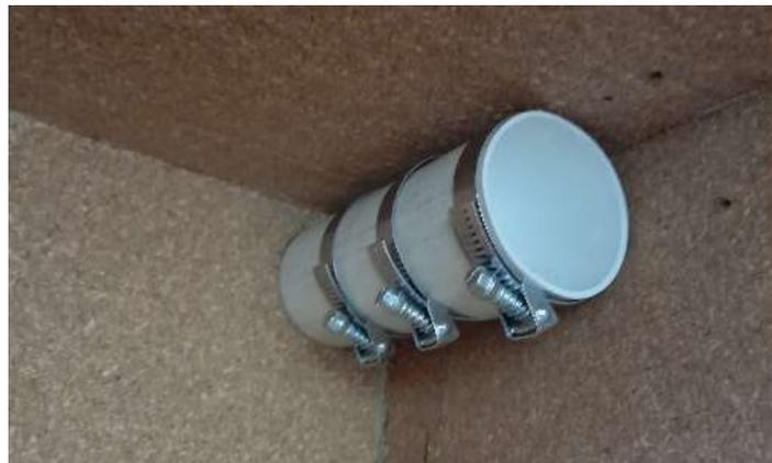
*Figura 2.12: ducto o respiradero de la caja acústica*
