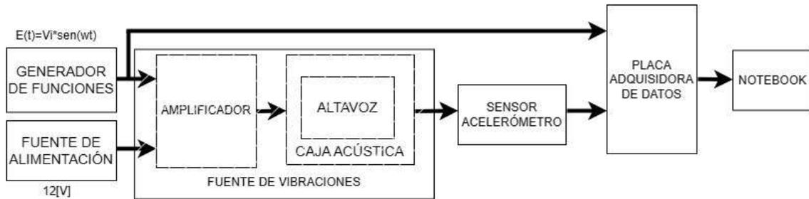
Figura 2.2: Diagrama en bloques del set-up experimental.
