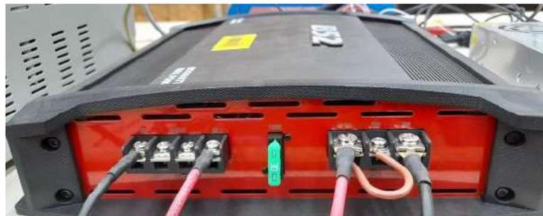
Figura 2.23: Conexión del altavoz y fuente de alimentación
