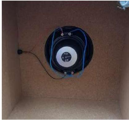
Figura 2.24: Conexión de las bobinas del altavoz
