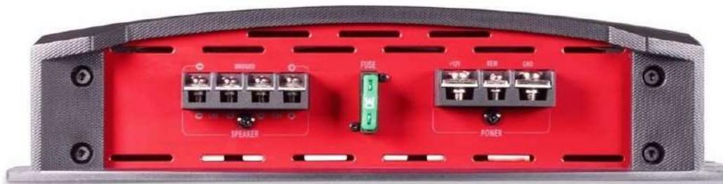
Figura 2.13: Lado del amplificador donde se conecta el altavoz y la alimentación
