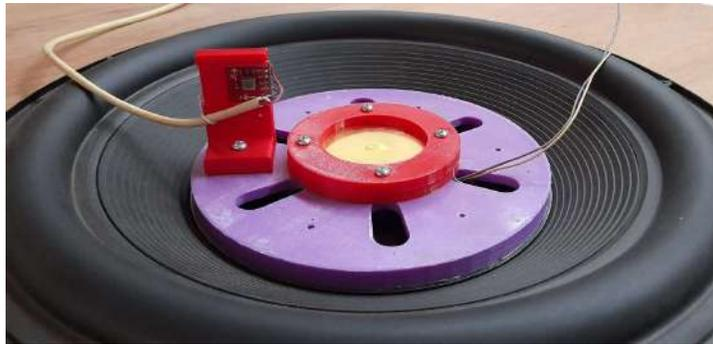
*Figura 2.20: base interface altavoz – acelerómetro – piezoeléctrico*
