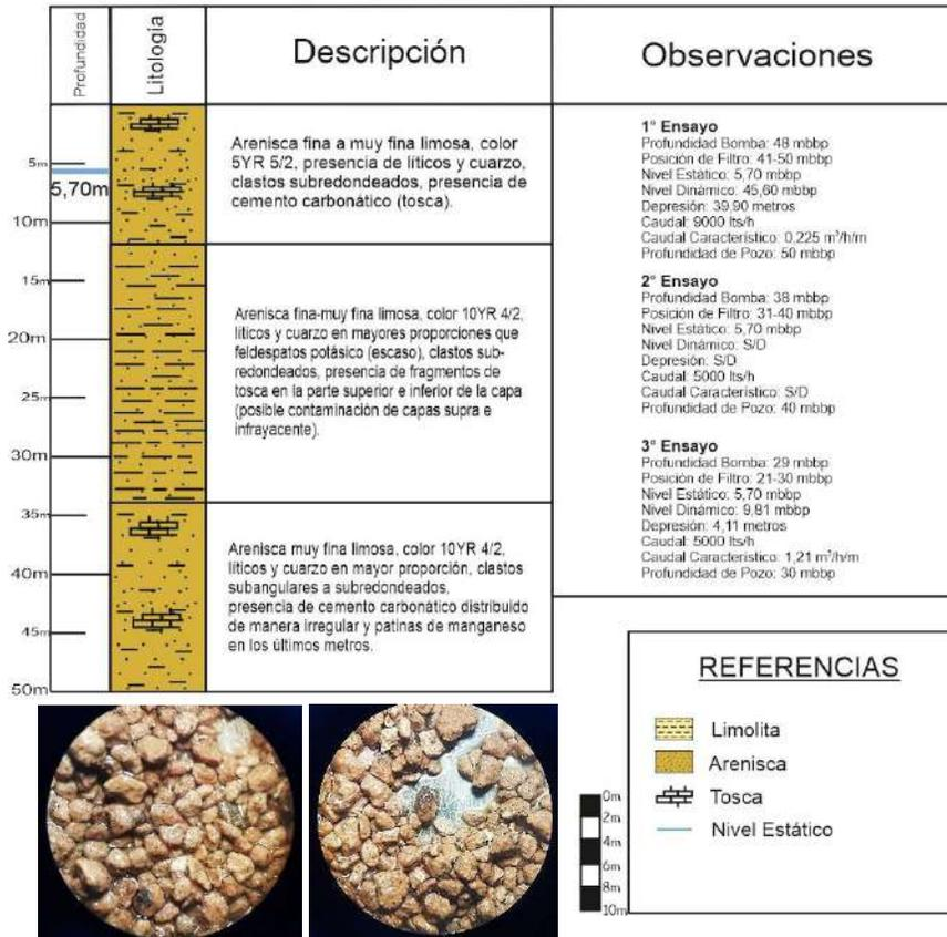
Figura 1. Columna estratigráfica y características hidráulicas del pozo A. *Cutting* realizado por el autor.
