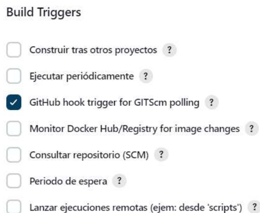
Figura 5.8: Configuración de Build triggers.
