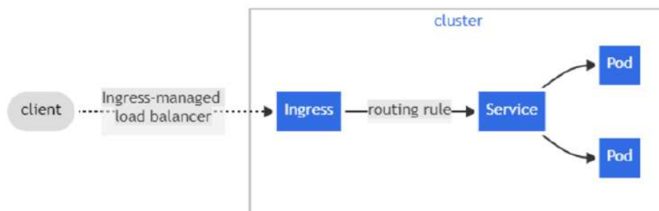
Figura 2.16: Ejemplo de un Ingress enviando tráfico hacia un servicio.
