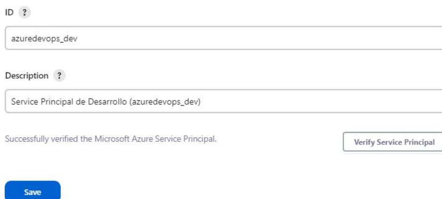
Figura 5.43: Creación de credencial para Azure Service Principal.
