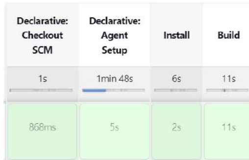
Figura 5.20: Visualización en la interfaz de Jenkins de la etapa que compila la aplicación Angular.
