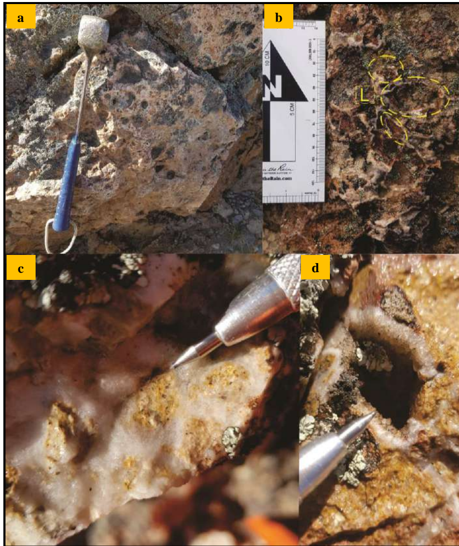
Figura 39: a) Afloramiento de la brecha con un ancho de 40 cm. b) Brecha donde se observan los fragmentos líticos (L) y la matriz de cuarzo. c) Fragmentos líticos (L) con pátinas de óxidos de Fe y matriz de cuarzo en detalle. d) Drusa de cuarzo.
