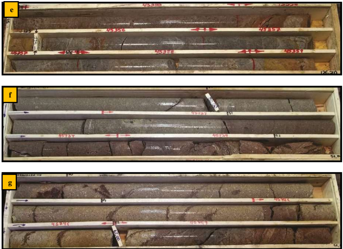
Figura 53: Variaciones litológicas de la Sección Centro. a) En los primeros 3 metros de perforación se encuentra la Ignimbrita rica en cristales con lajosidad, de 0 a 3,30 m. b) Ignimbrita rica en cristales con estructura masiva, de 28,75 a 31,53 m. c) Ignimbrita rica en cristales con fiammes grandes con óxidos e hidróxidos de Fe, de 72,70 a 75,40 m. d) Zona de falla, de 32,10 a 34,13 m. e) Ignimbrita rica en cristales con 10 % de venillas de cuarzo y presencia de pirita, de 123,95 a 126,70 m. f) Ignimbrita rica en cristales con alteración clorítica, de 49,53 a 52,10 m. g) Ignimbrita rica en cristales con alteración cuarzo-sericita, venillas de óxidos e hidróxidos de Fe y venillas de cuarzo, de 59,85 a 62,60 m.
