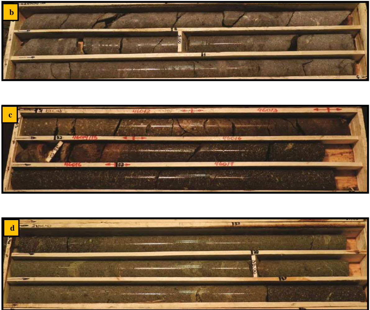
Figura 56: Variaciones litológicas de la Sección transversal Norte. a) En los primeros 3 metros de perforación se encuentra la Ignimbrita rica en cristales con lajosidad, de 0 a 3,50 m. b) Ignimbrita rica en cristales con estructura masiva presente durante 28 m, de 3,50 a 6,40 m. c) Ignimbrita rica en cristales con fiammes menores a 2 cm con venillas de cuarzo en 1 % y evidenciando la presencia de óxidos e hidróxidos de Fe, de 31 a 33,70 m. d) Ignimbrita rica en cristales con fiammes grandes próxima a zona de venillas, presentando alteración clorítica, de 36,40 a 39,20 m.
