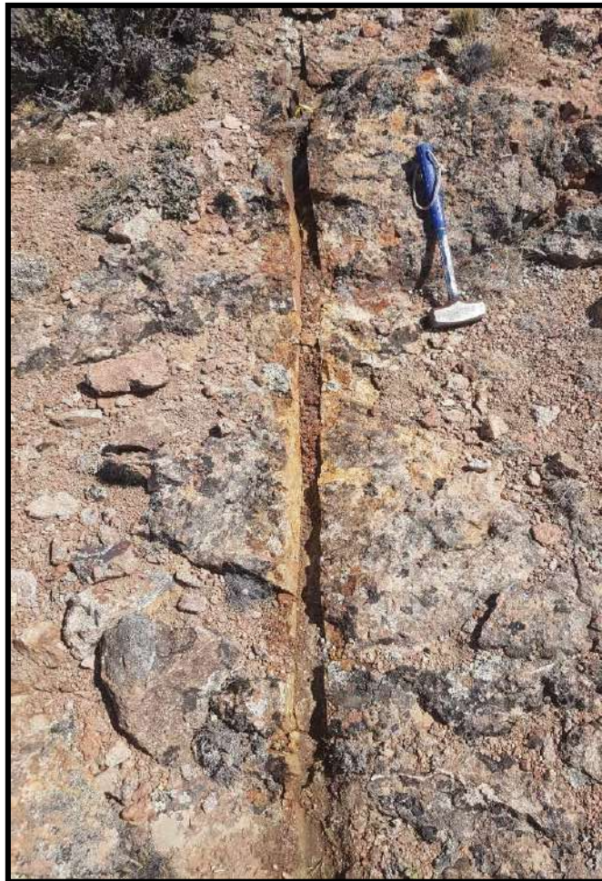
Figura 46: Muestreo de tipo canaleta sobre veta Névida.
