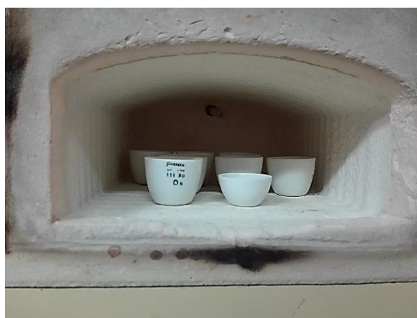
Figura 6. Crisoles en mufla con etiquetas autoadhesivas conteniendo el sedimento eólico.
