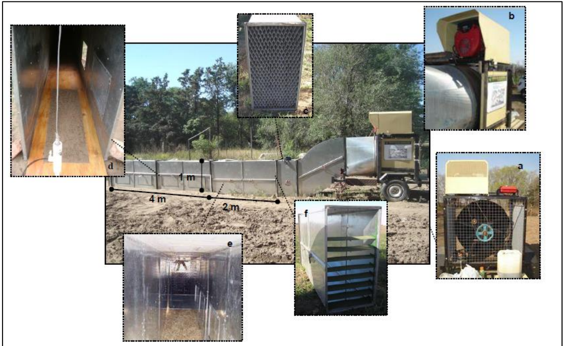
Figura 3. Componentes del túnel de viento portátil. a) Hélice, b) motor con carcasa protectora, c) placa cribada, d) zona de medición (4 m), e) tramo del túnel con piso (2 m), f) chapas deflectoras. Imagen tomada de Mota, G. (2014).
