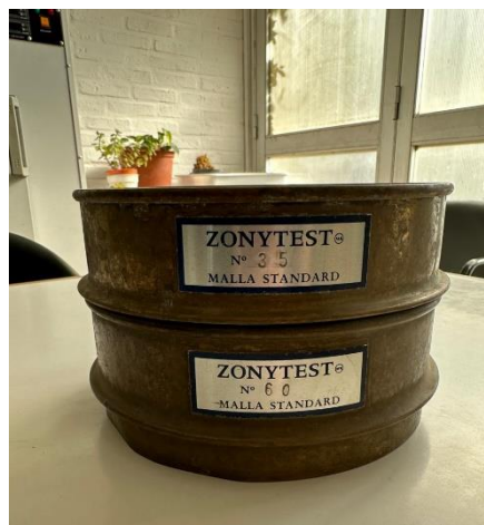
Figura N° 6. Tamices N° 35 y 60, con mallas de 500 y 250 micrones, respectivamente.
