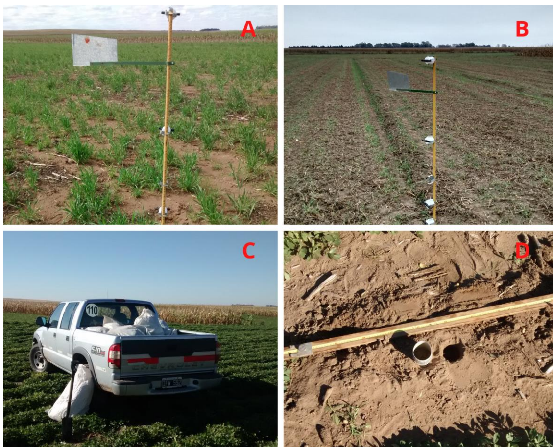
Imagen 3: a) colector de erosión en sitio 1, b) colector de erosión en sitio 2, c) recolección de material para estimar rinde, d) toma de muestra para calcular humedad de suelo.
