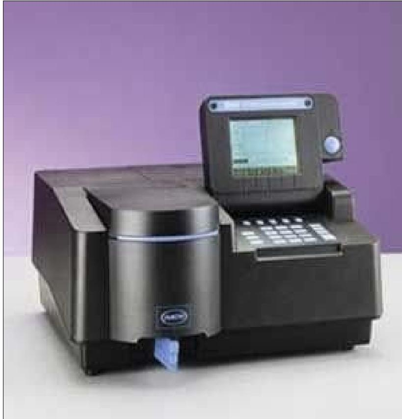
**Figura 5.2.** Espectrofotómetro UV/visible Hach Dr 5000.
