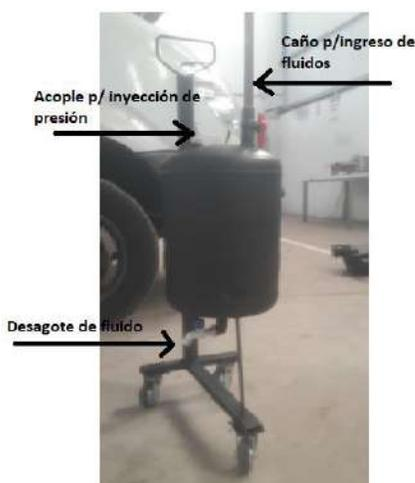
Figura 6.6: Equipo para extracción de fluidos
