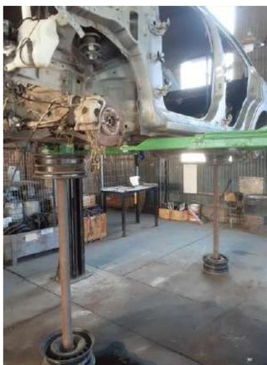
Figura 6.5: ubicación de soportes para trabajo en altura.
