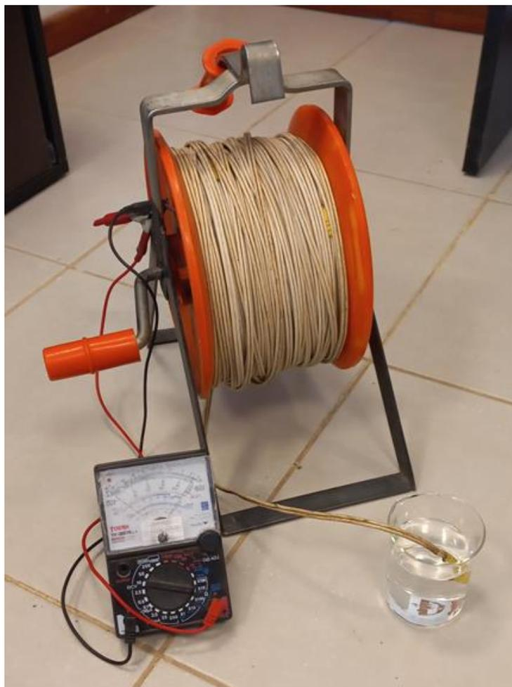
Figura 4.2: Sonda Piezométrica utilizada para mediciones de niveles.
