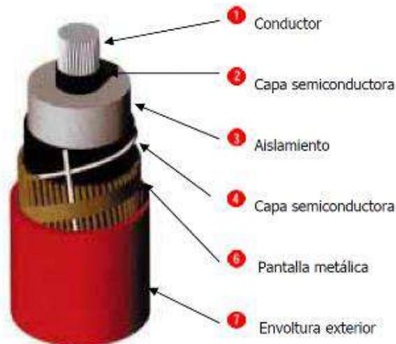
Imagen 2.5.2-1: composición del conductor subterráneo de media tensión
