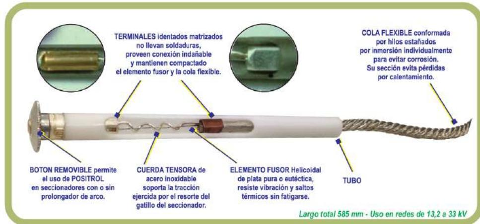
Imagen 2.5.3-3: Elemento fusible media tensión –Composición
