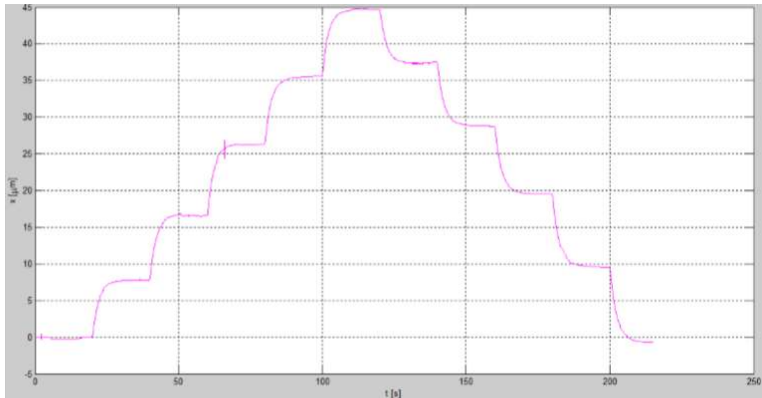
Figura 26 - Desplazamiento del área móvil de trabajo del flexure stage.
