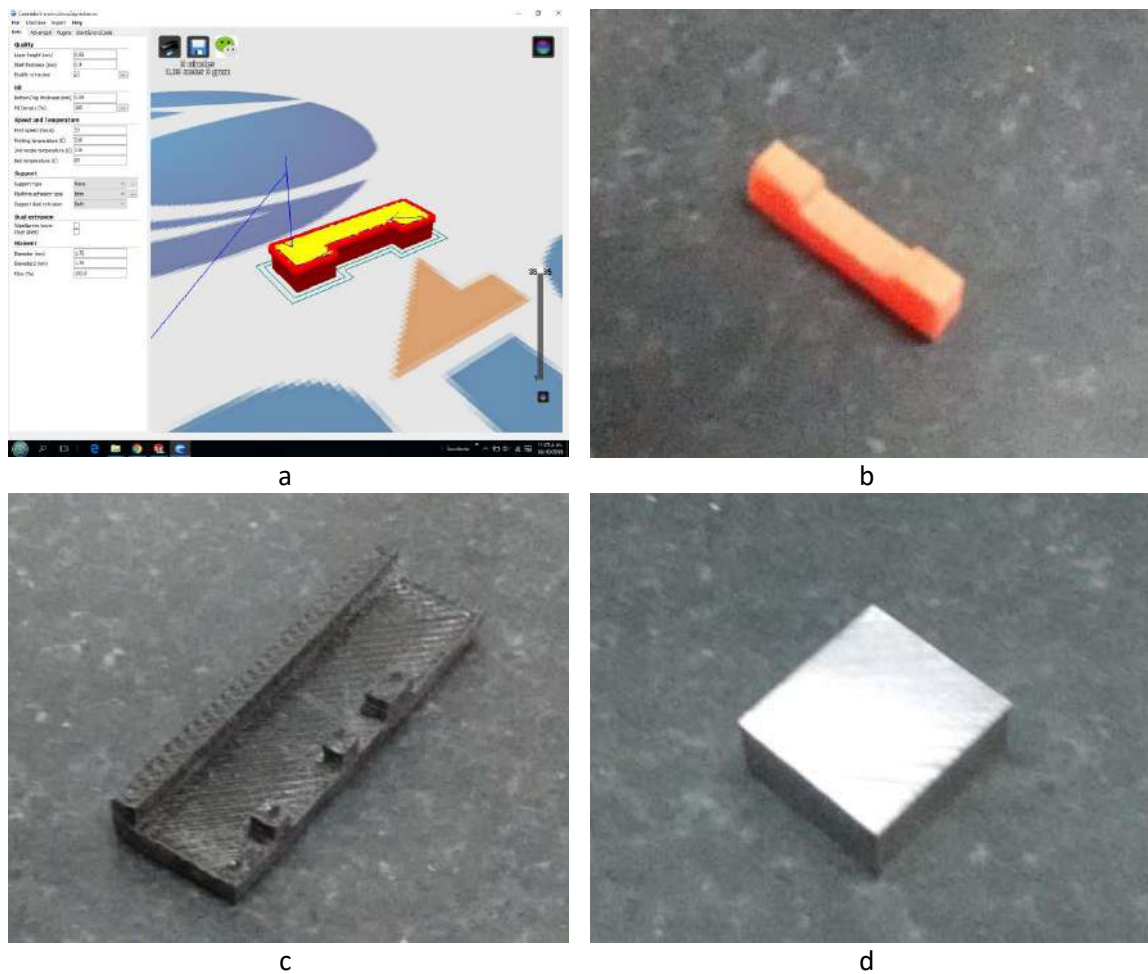
Figura 14 -a) Diseño de soporte en impresora 3D. b) Soporte de piezo chico. c) Soporte de piezo grande. d) Suplemento metálico.
