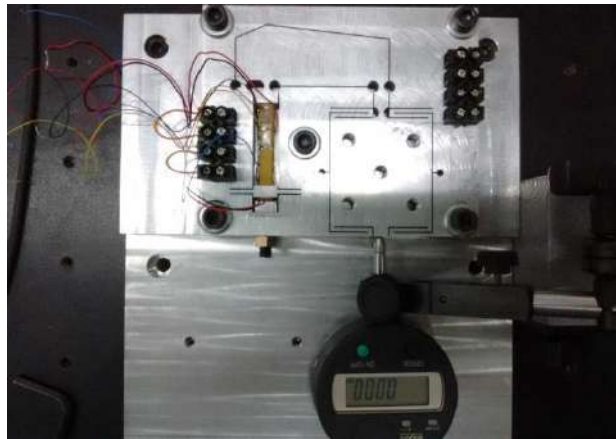
Figura 17 - Flexure fijado a la base con contratuerca y comparador para medir la precarga.
