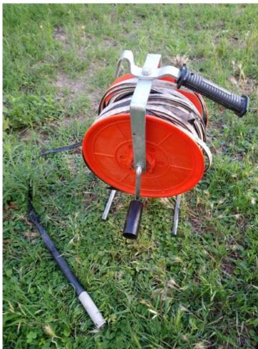
**Figura 4.14:** Sonda graduada de 50 m para medir la profundidad del nivel freático.
