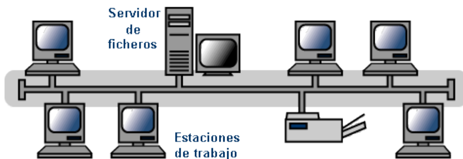
Figura 5.2: backbone en cascada (también llamado topología Bus)
