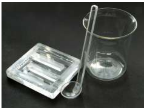
Figura 3: Cámara de recuento de Bogorov y submuestreador de Russell.
