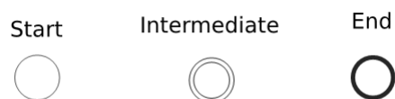
Figura A1.1: Representación gráfica de los tres tipos de evento básicos en BPMN. Imagen extraída de [2].
