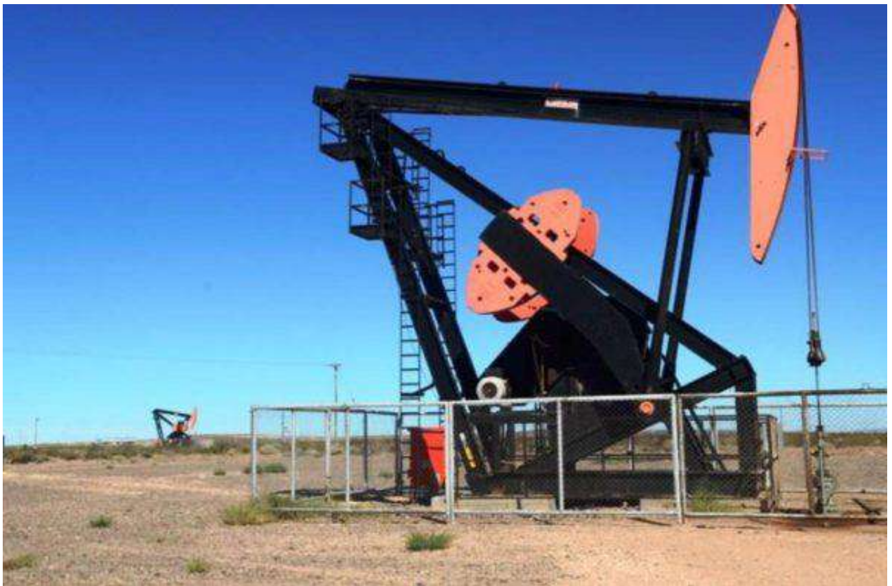
Imagen 85: AIB – Bomba de Varilla
