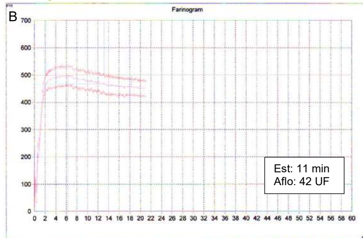
Figura 32: Curvas de farinograma: eje Y=UF= unidades farinográficas, eje X= minutos. Est= estabilidad= tiempo entre que la parte superior de la curva alcanza las 500 UF y el punto en el que la parte superior cruza nuevamente la línea de 500 UF. AFLO=aflojamiento= la diferencia de UF entre el centro de la curva de máxima consistencia y el centro de la curva 12 minutos después. (A) Testigo y (B) Fertilizado.
