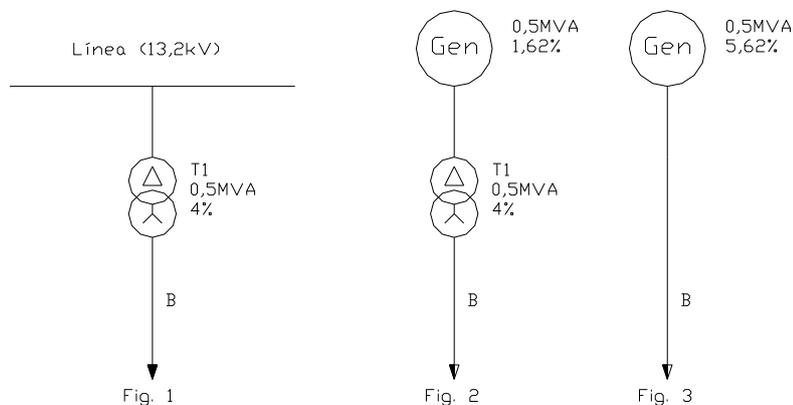
En un principio, tendríamos lo correspondiente a la figura nº1, pero si sustituimos a la línea por un generador de igual potencia a la del trafo (500kVA) pero con la correspondiente potencia de cortocircuito ( $P_{cc}=30,91\text{MVA}$ ), se tiene que la reactancia subtransitoria será:
