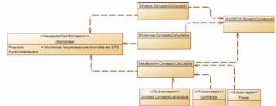
Figura 6. Diagrama de objetos que relaciona la necesidad de información con los conceptos calculables, subconceptos y modelo conceptual
