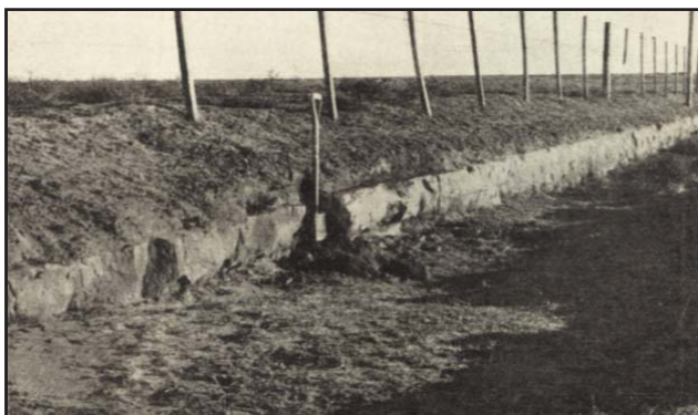
Suelo negro, consistente, cubierto por suelo arenoso suelto, que es fácilmente movido por el viento; camino de Pico a Metileo (La Pampa).
