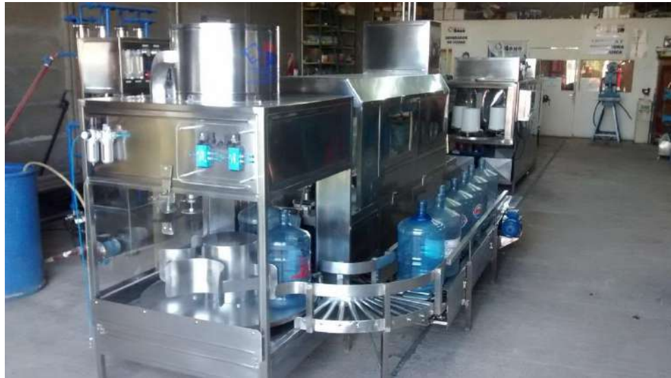
Imagen 13: Máquina de lavado y llenado de bidones automática (2).
