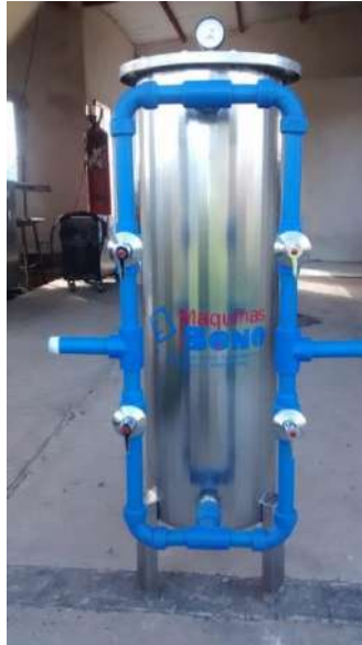
Imagen 9: Filtro de carbón activado.
