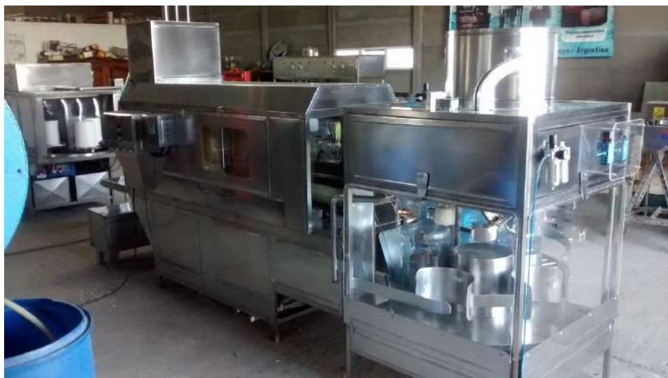
Imagen 14: Máquina de lavado y llenado de bidones automática (3).
