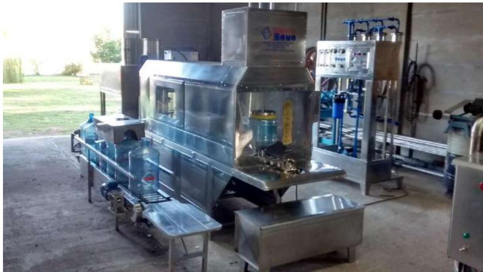
Imagen 12: Máquina de lavado y llenado de bidones automática (1).
