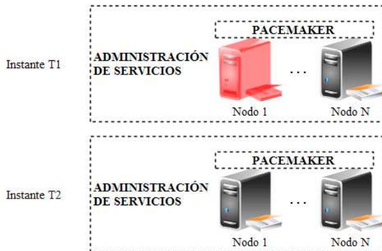
Fig. 5.4 – Funcionamiento de Pacemaker ante el fallo de una instancia de Asterisk
