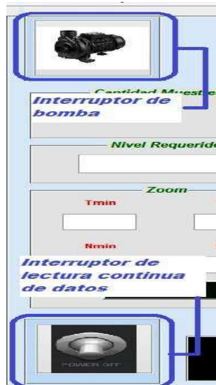
Figura 103: Interruptores de encendido de bomba y de lectura de datos. Submenú de Evolución en tiempo real.
