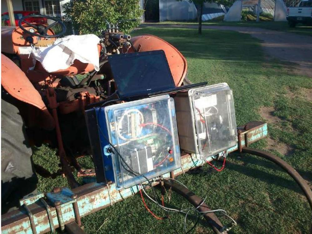
Figura 3.15: Sistema de adquisición instalado en el tractor.
