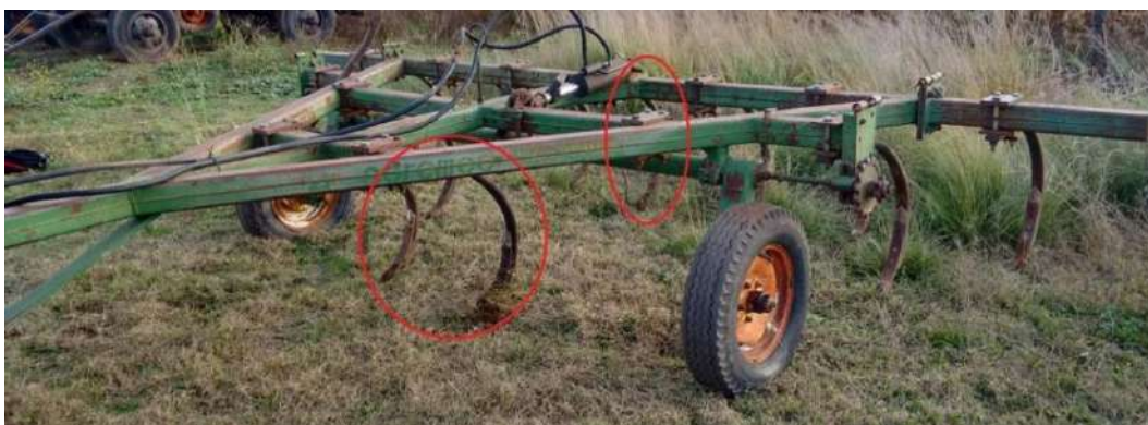
Figura 4.1. Cincel agrícola y púas extraídas.
