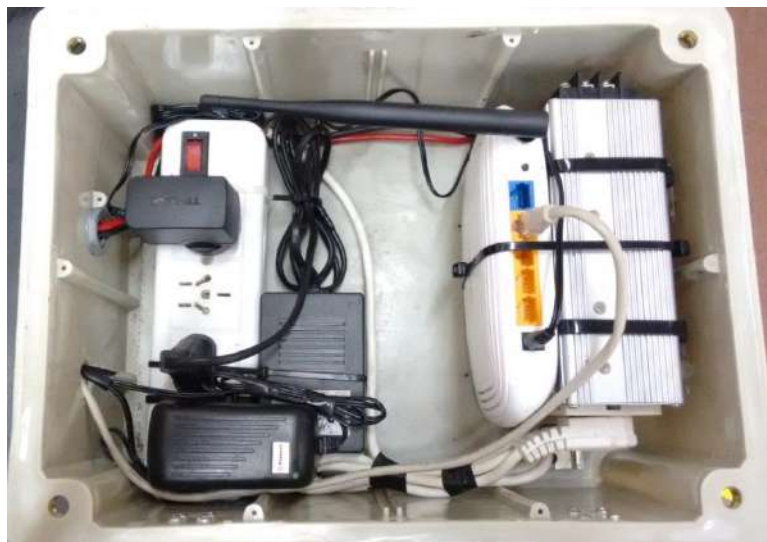
Figura 4.13. Incorporación de router.
