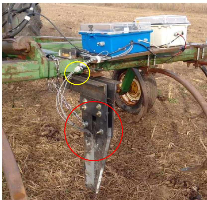
Figura 4.15. Montaje de cuchilla y sistema de adquisición de datos.
