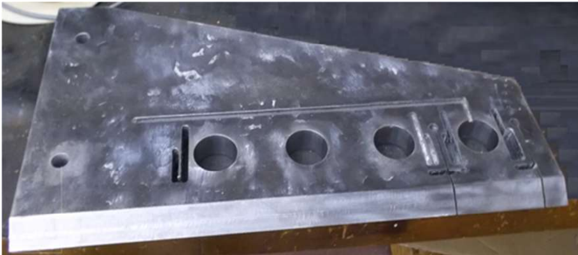
Figura 2.3: Cuchilla previa al maquinado.
