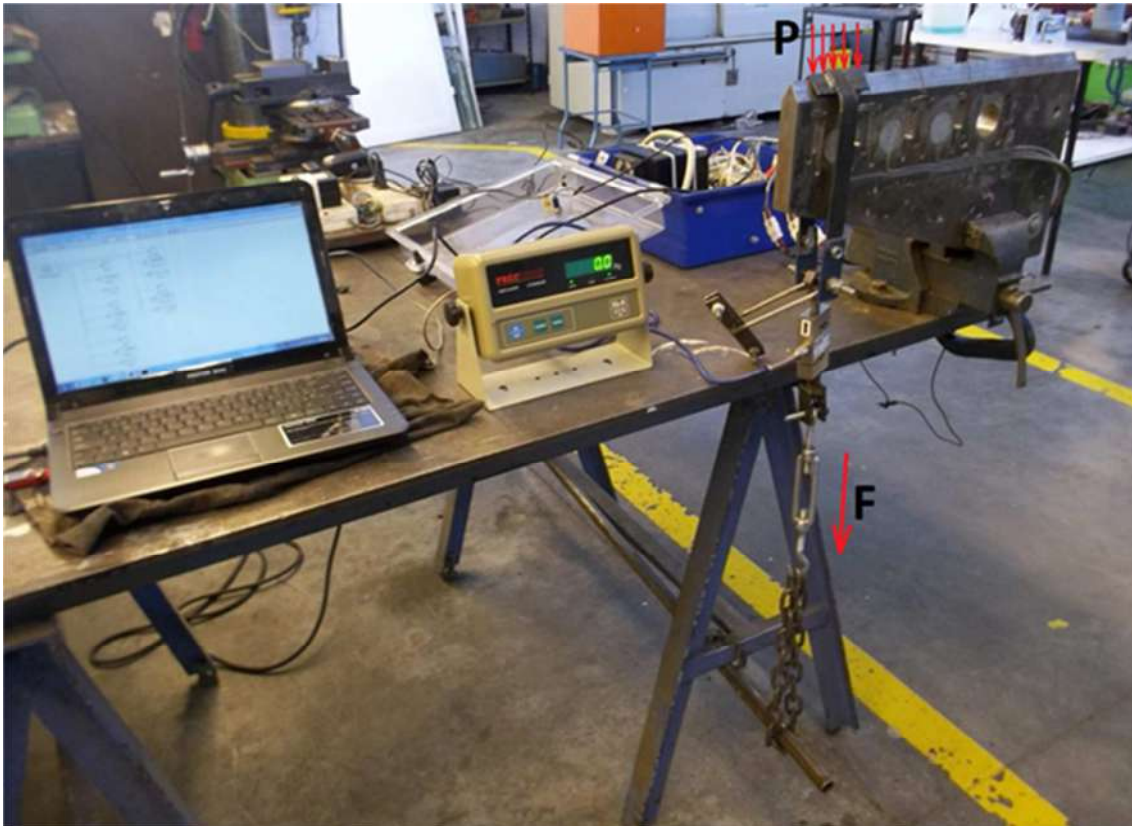
Figura 4.3: Banco de prueba listo para los ensayos de calibración.
