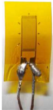
Figura 3.12: Strain gauge con terminales soldados.
