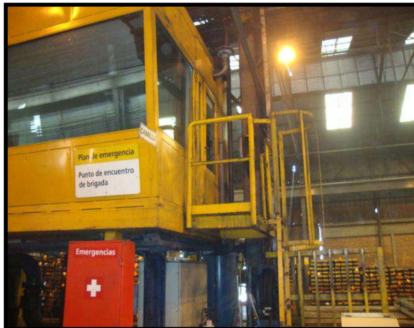
Fig.47: Ejemplo empleo del color amarillo en cabina de puente grúa.
