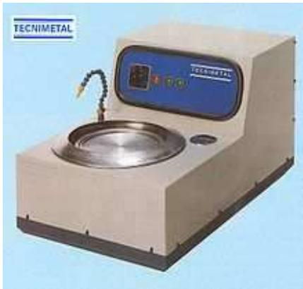
general, se realiza en forma mecánica y se utiliza un paño impregnado con partículas de algún abrasivo en solución acuosa. Básicamente, se pueden utilizar dos tipos de paños: con pelo (pana, terciopelo, lanas) y sin pelo (seda natural). Se debe elegir el que más se adapte al tipo de material a examinar. Por ejemplo, el pulido de muestras de fundición se
