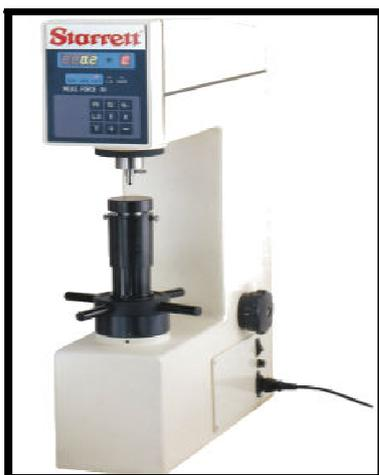
**1-Durómetro automático Starret 3816 Rockwell.**
