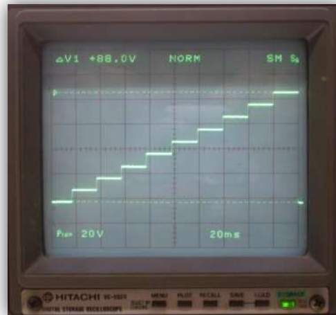
Figura N°6: Señal tipo escalera ascendente de 5Hz. Imagen sacada de la pantalla del osciloscopio del laboratorio.
