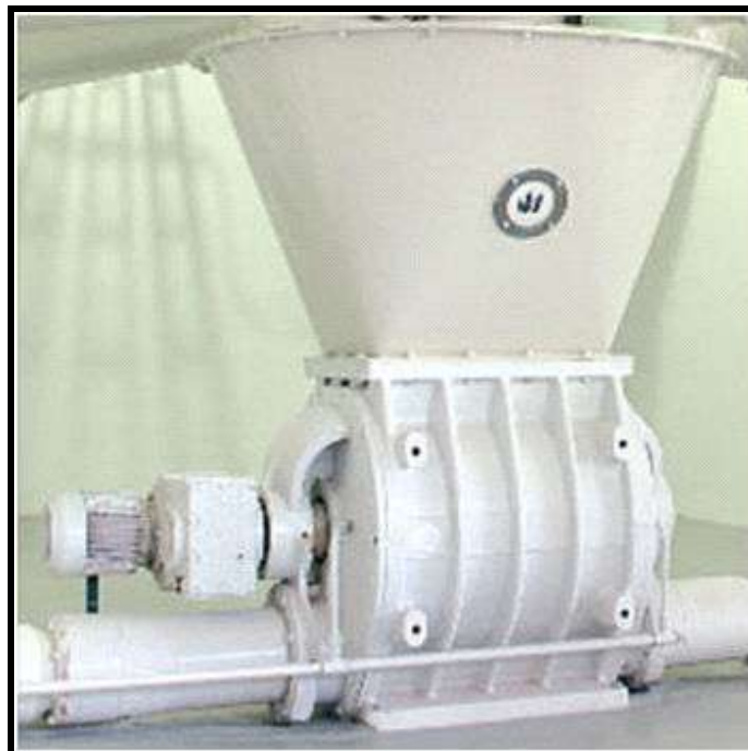
Figura 22: Esclusa de soplado para transporte neumático.
