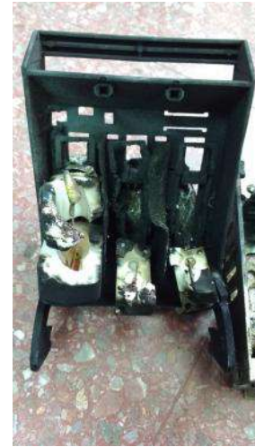
Figura 2: Seccionadora tripolar bajo carga T0 hasta 160A
