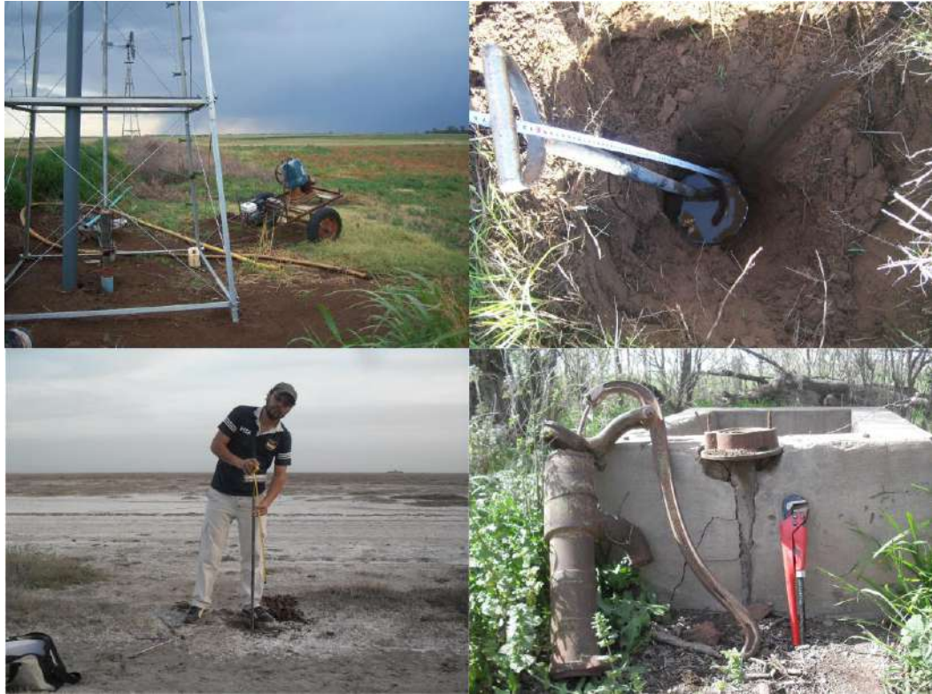
Figura A9. Diferentes sondeos de medición del nivel freático.
