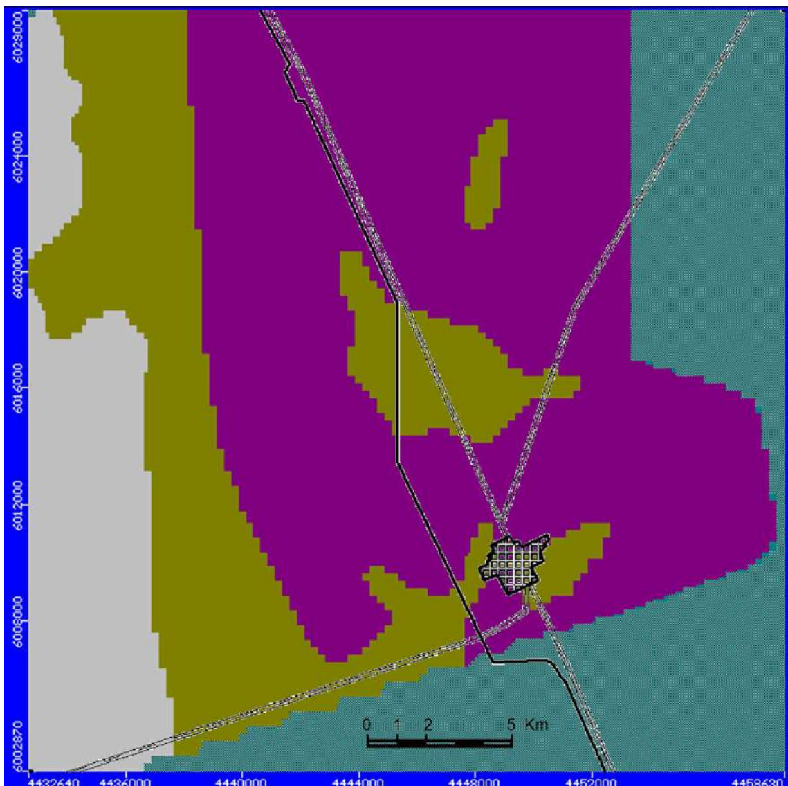
Figura 3.17. Mapa de conductividad hidráulica de la capa inferior.
